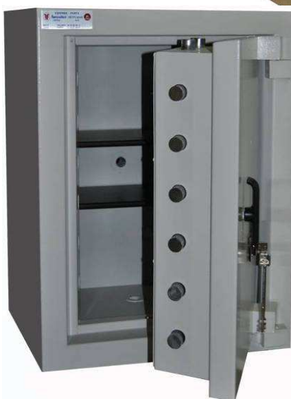
GP 47 classe IVE A2P H : 800 L : 600 P : 500 mm 560 Kg pour 85 Litres 2 serrures à clé double panneton
