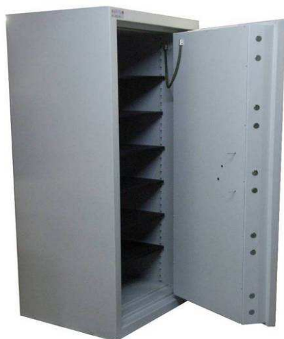
GP Base Technique classe VE H : 1800 L : 900 P : 750 mm Poids 2200 Kg Serrure à clé double panneton + combinaison 4 tubes compteurs + serrure horaire
